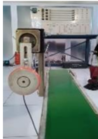
Gambar 14. Tahapan proses lengan rejector terhadap botol dengan kondisi tutup botol minuman tidak sempurna sensor #3 dan #2 kondisi OFF
