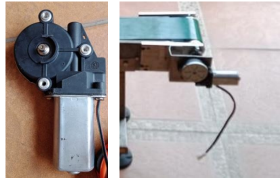
Gambar 5. Bentuk fisis motor dc untuk gearbox dan pemasangannya pada rangka miniatur mesin konveyor
