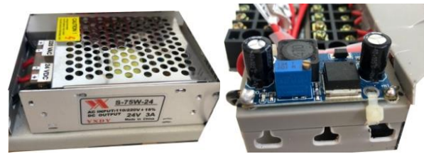
Gambar 8. Bentuk fisis switched mode power supply 24 Vdc dan modul regulator tegangan dc
